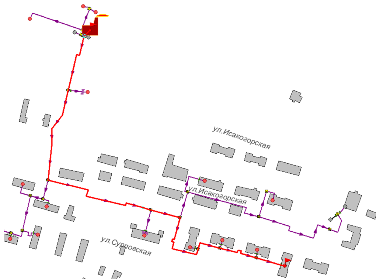
Рисунок 1.17 -Расчетный путь теплоносителя котельной до Сурповской, д. 20
