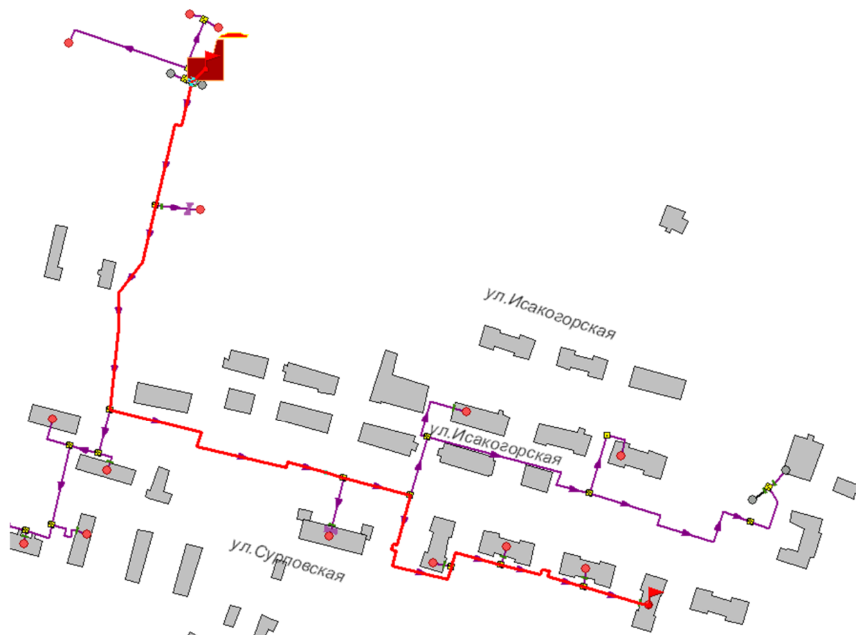
Рисунок 2.17 -Расчетный путь теплоносителя котельной до Сурповской, 20
