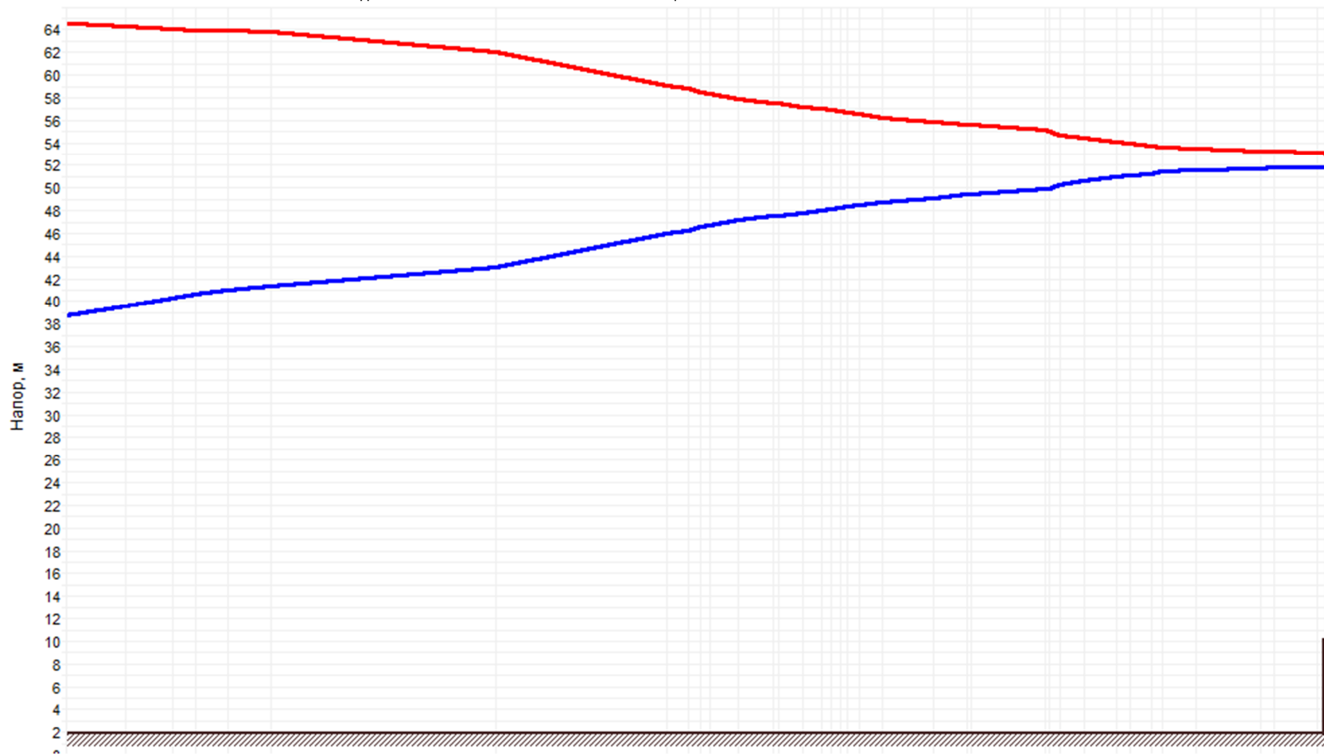
Рисунок 3.64 –График гидравлических режимов рассматриваемого теплопровода
