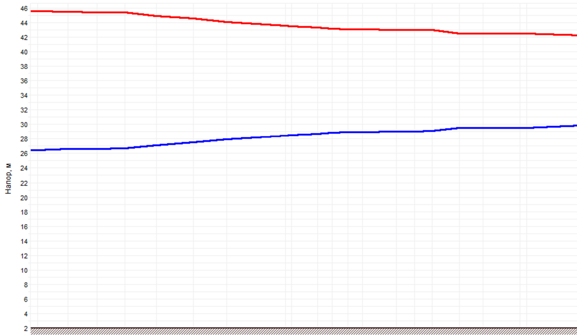
Рисунок 2.16 –График гидравлических режимов рассматриваемого теплопровода
