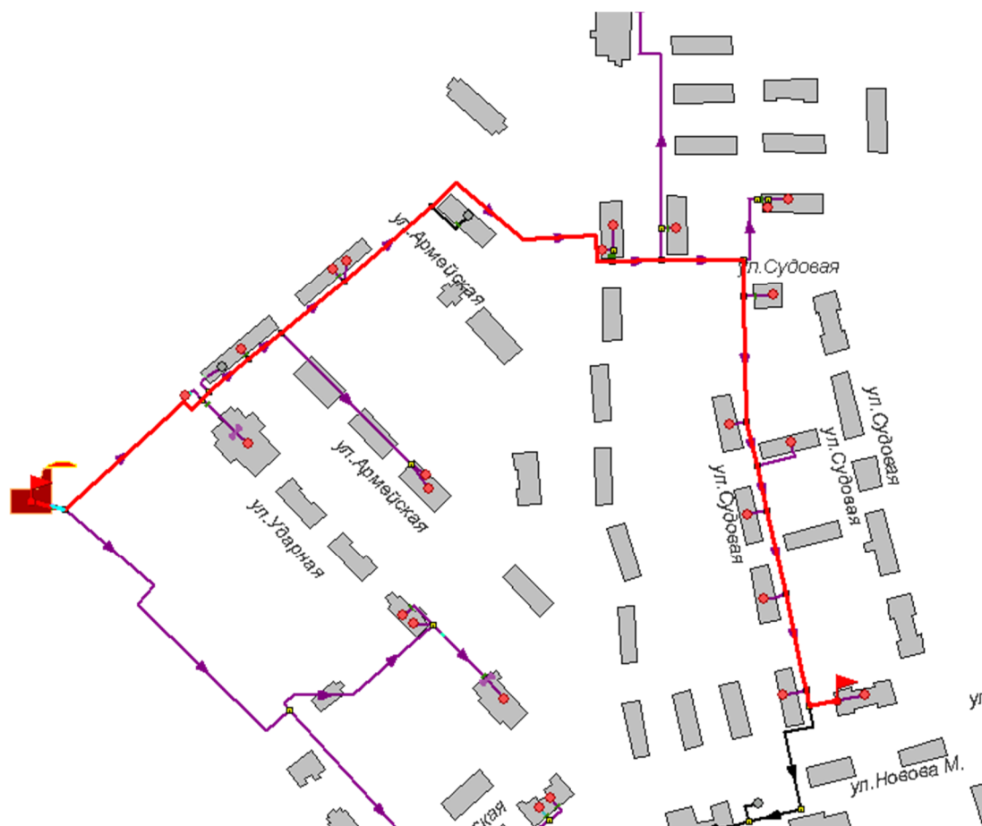
Рисунок 3.83 -Расчетный путь теплоносителя от котельной до Новова,17
