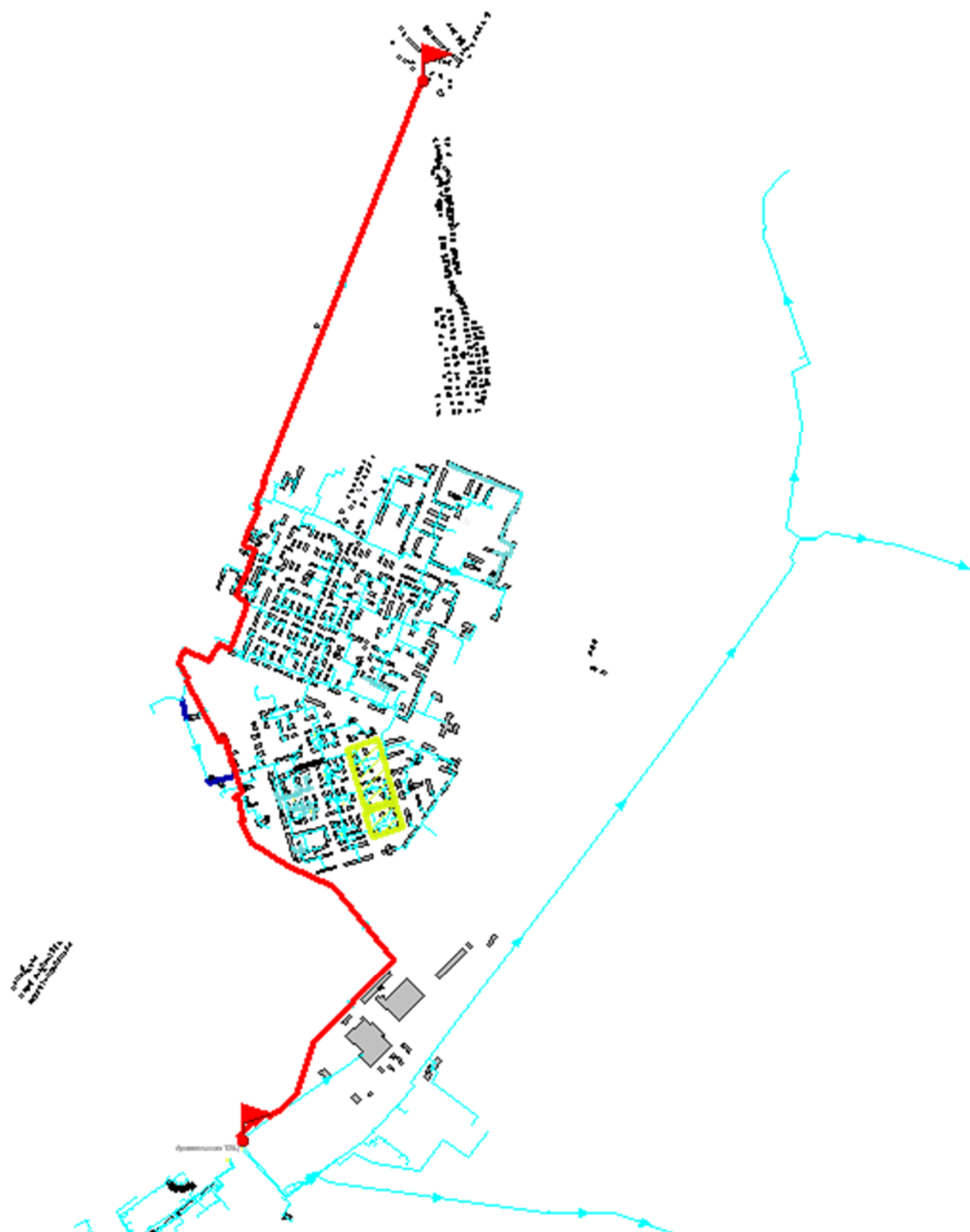
Рисунок 1.1-Расчетный путь теплоносителя №1 от Архангельской ТЭЦ.
