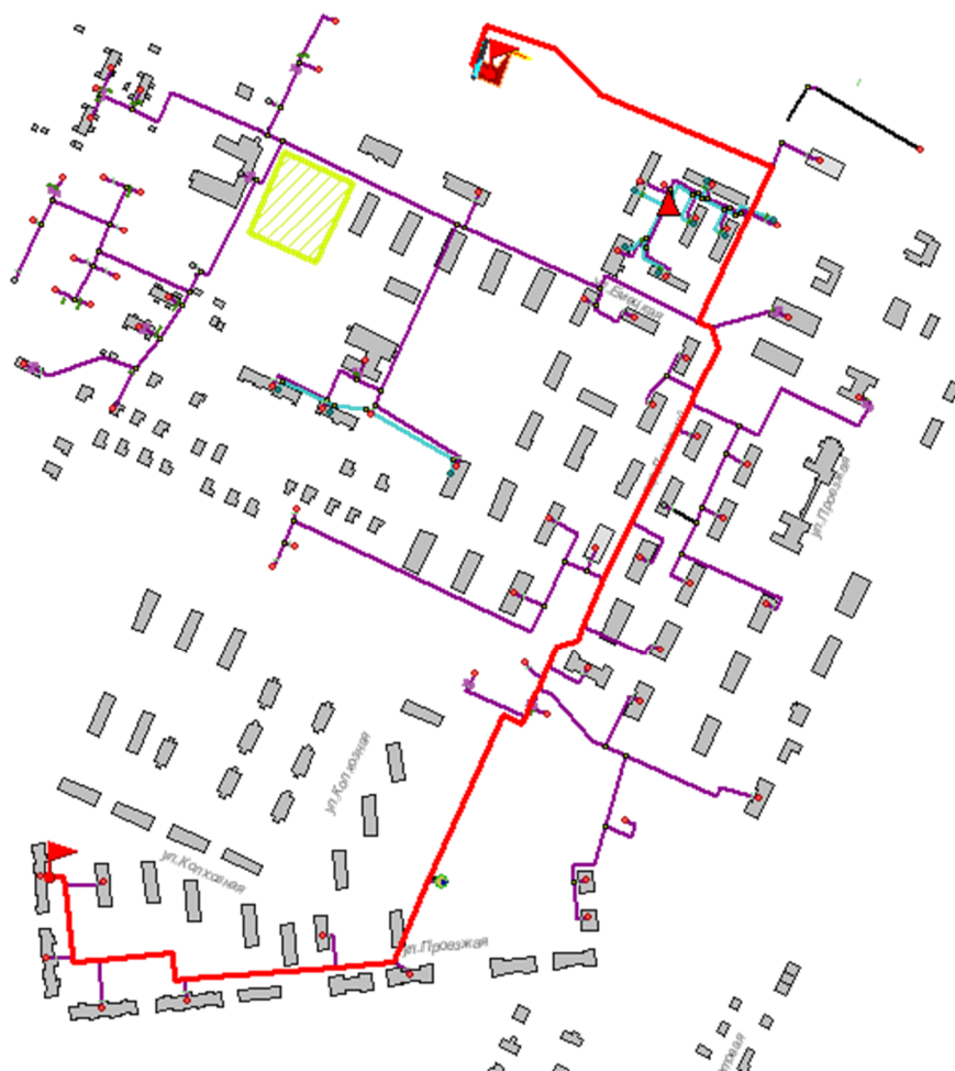
Рисунок 2.65 -Расчетный путь теплоносителя котельной до Колхозная,35
