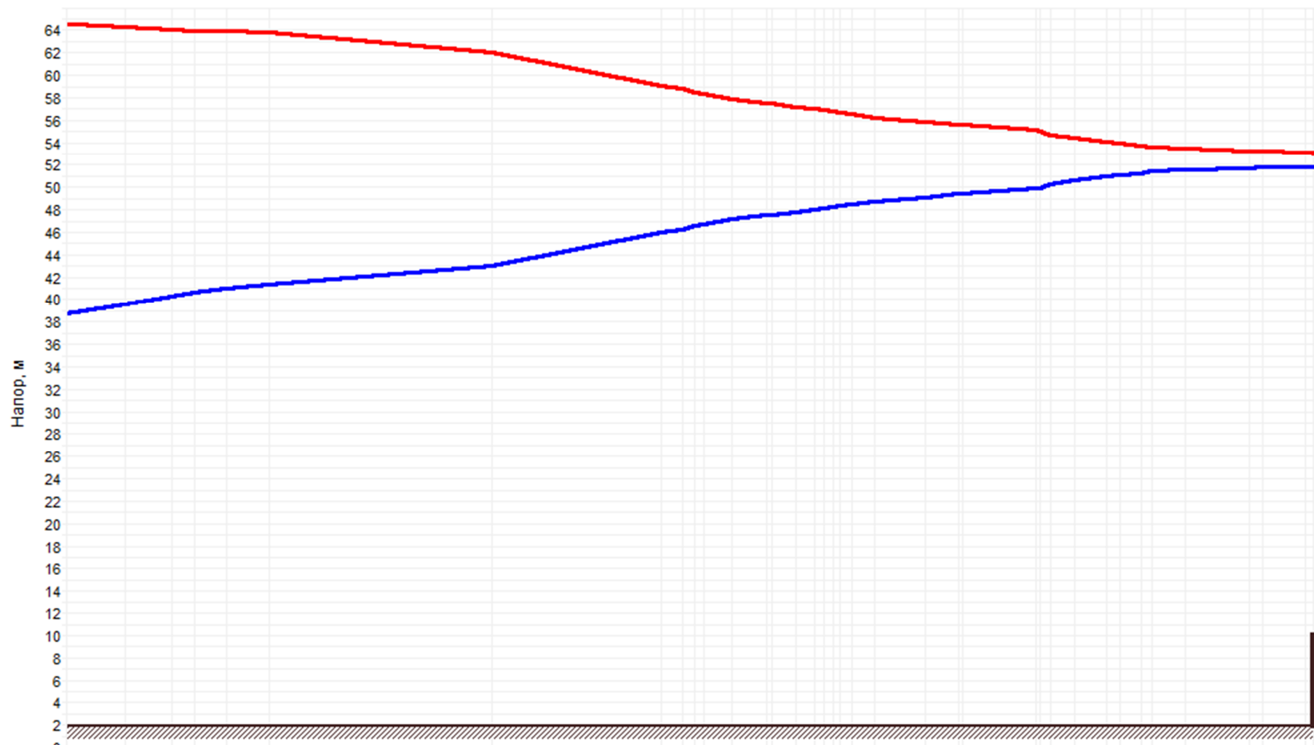
Рисунок 1.64 –График гидравлических режимов рассматриваемого теплопровода
