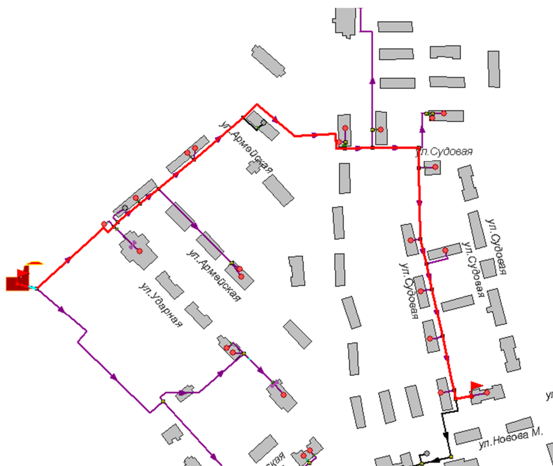
Рисунок 1.83 -Расчетный путь теплоносителя от котельной до Новова,17
