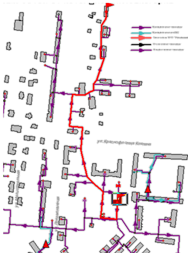
Рисунок 2.45 -Расчетный путь теплоносителя от котельной до Локомотивная,1
