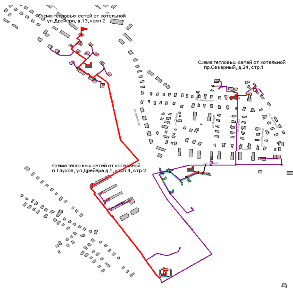
Рисунок 3.19 -Расчетный путь теплоносителя от котельной до Дрейера, д.9, к.2
