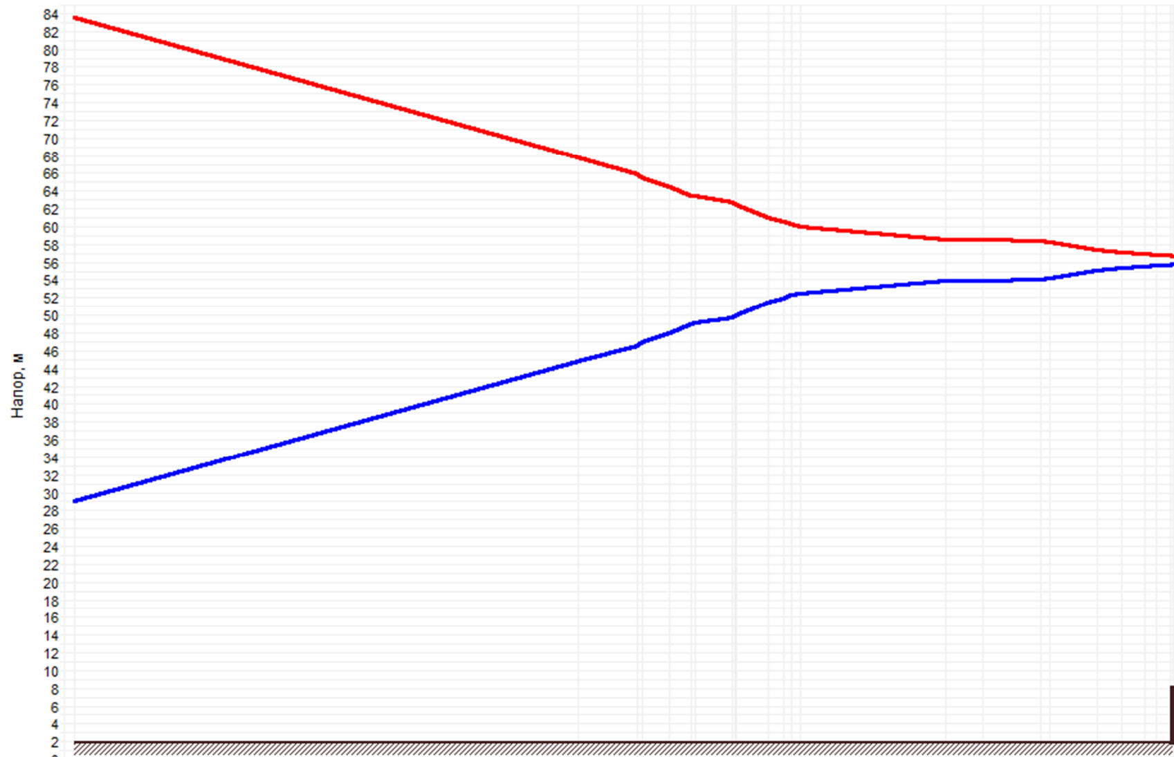
Рисунок 3.24 –График гидравлических режимов рассматриваемого теплопровода
