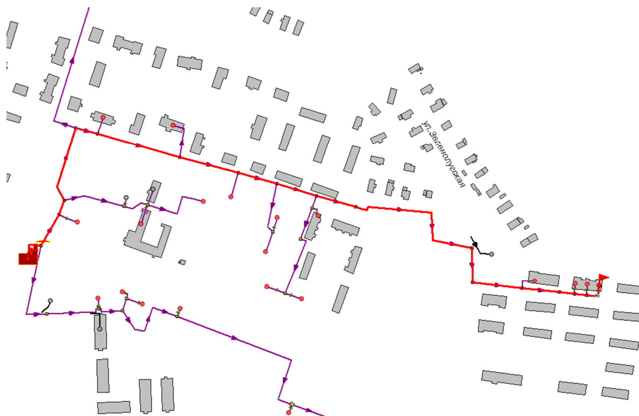
Рисунок 3.13 -Расчетный путь теплоносителя котельной до КЛДК 23, УУ1
