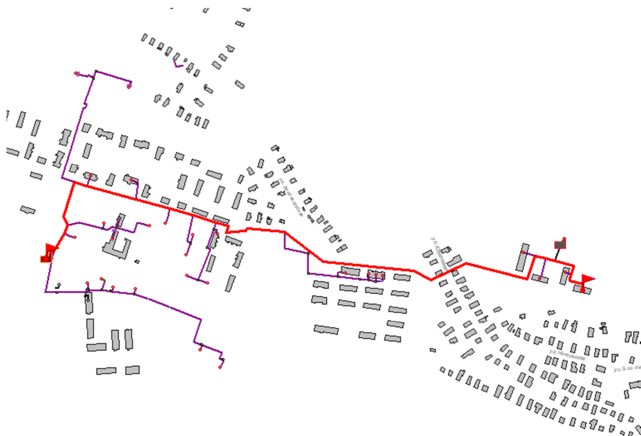
Рисунок 1.13 -Расчетный путь теплоносителя котельной до Аэропорт, 39
