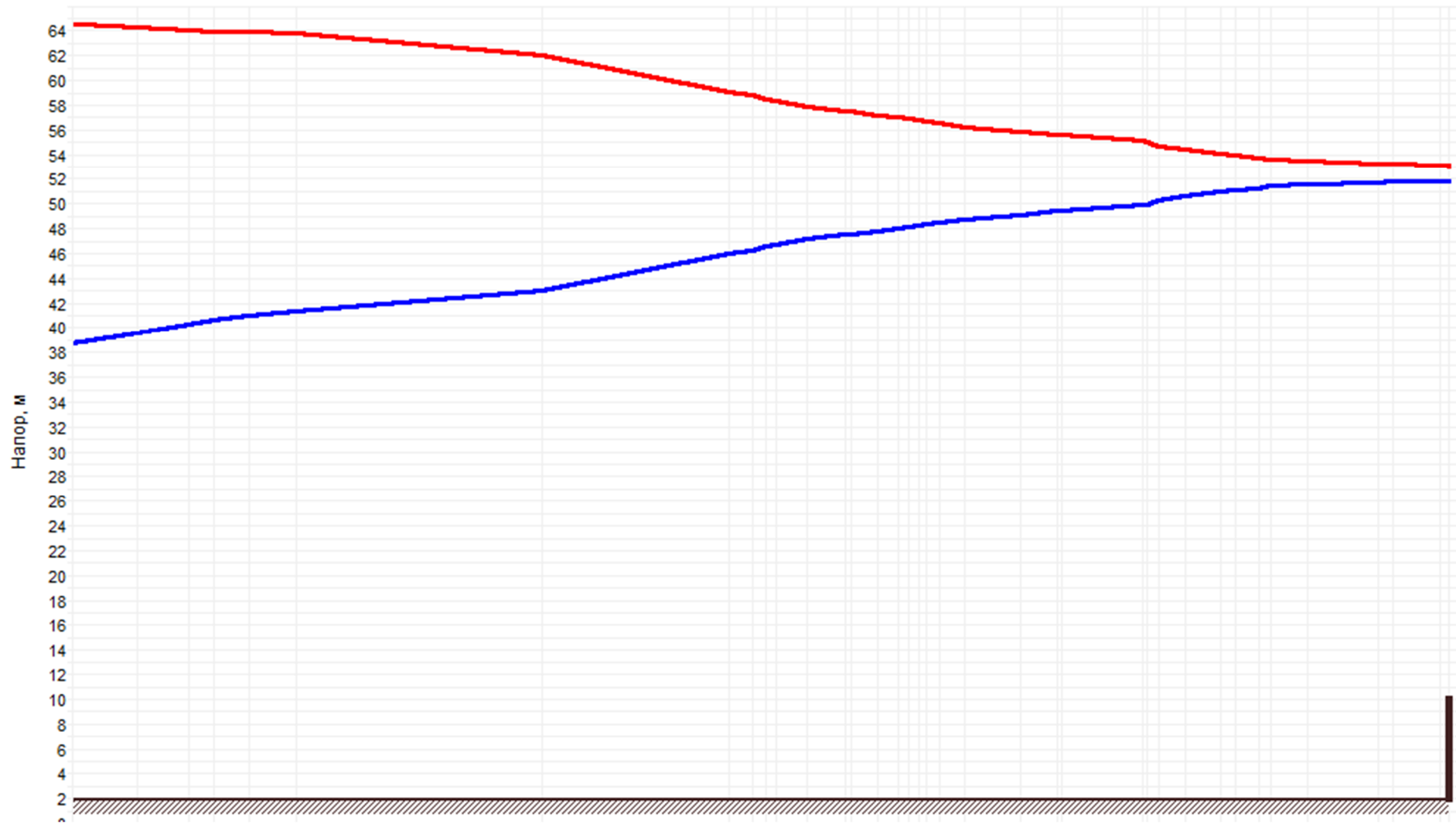
Рисунок 2.64 –График гидравлических режимов рассматриваемого теплопровода
