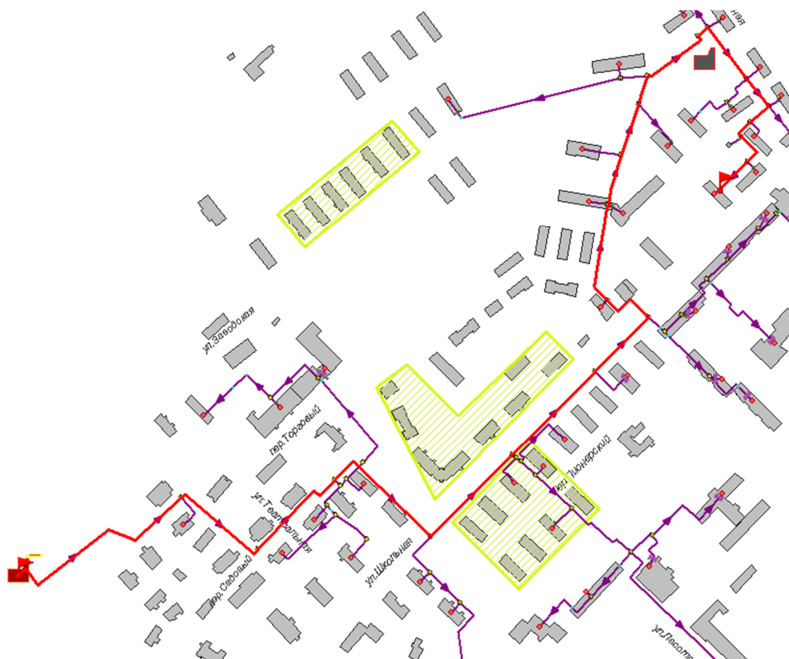
Рисунок 2.81 -Расчетный путь теплоносителя котельной до Школьная,162
