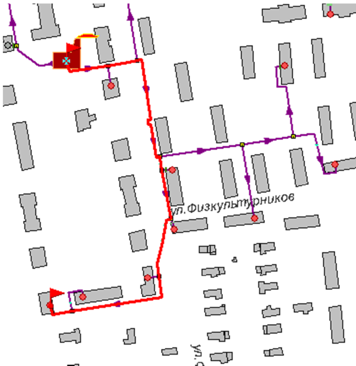
Рисунок 2.69 -Расчетный путь теплоносителя от котельной до Маслова,23 к.1
