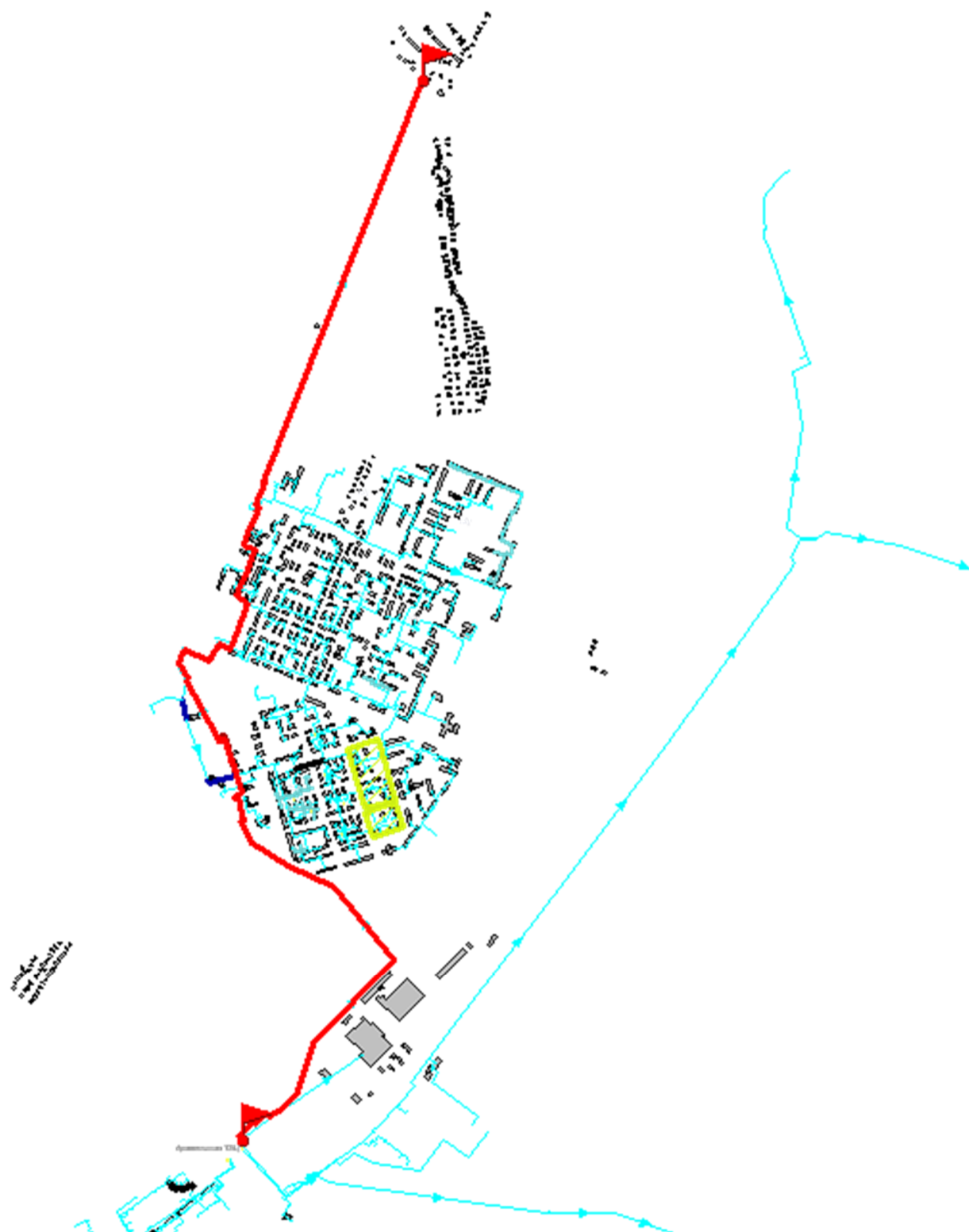
Рисунок 2.1-Расчетный путь теплоносителя №1 от Архангельской ТЭЦ.
