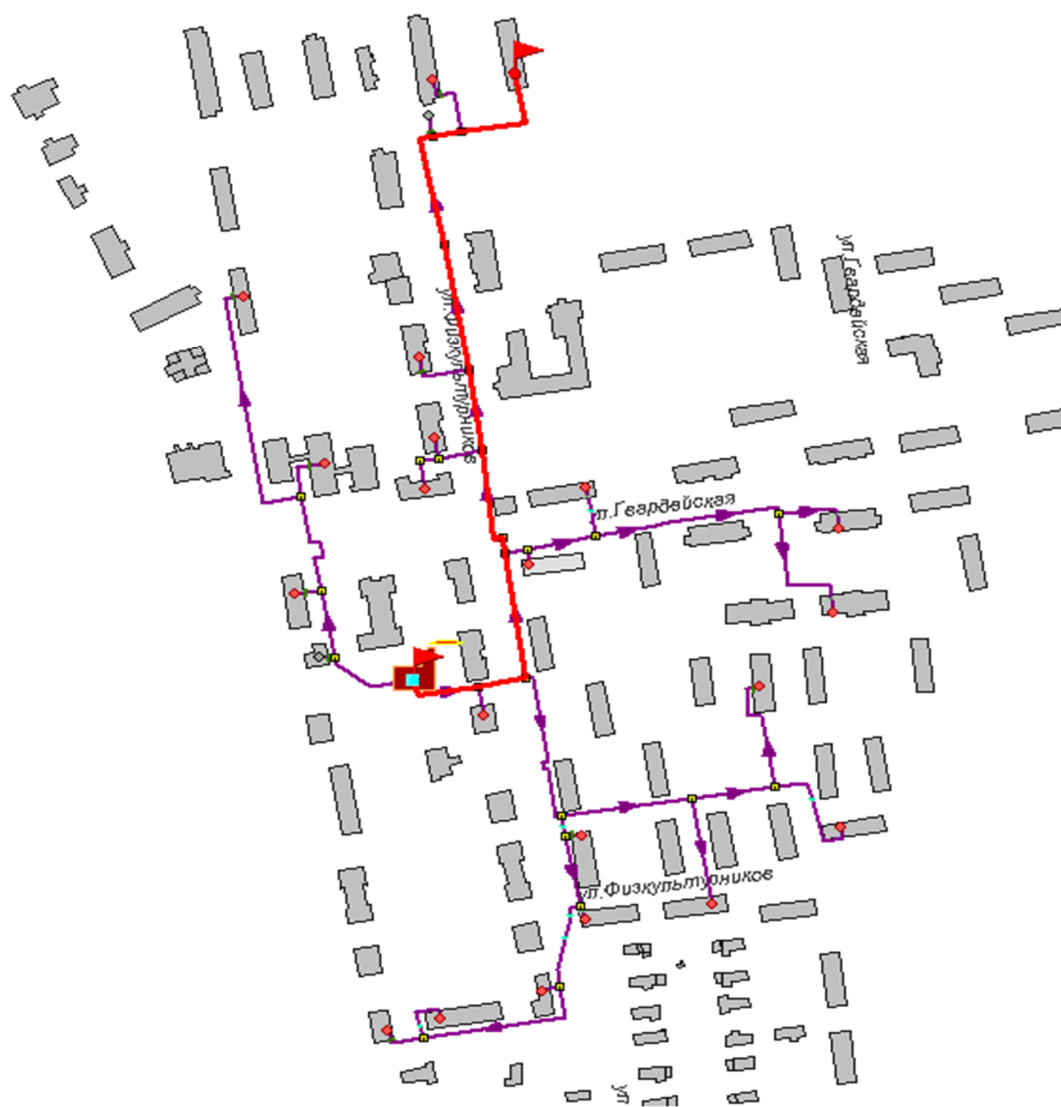
Рисунок 3.67 -Расчетный путь теплоносителя от котельной до Петрова,9
