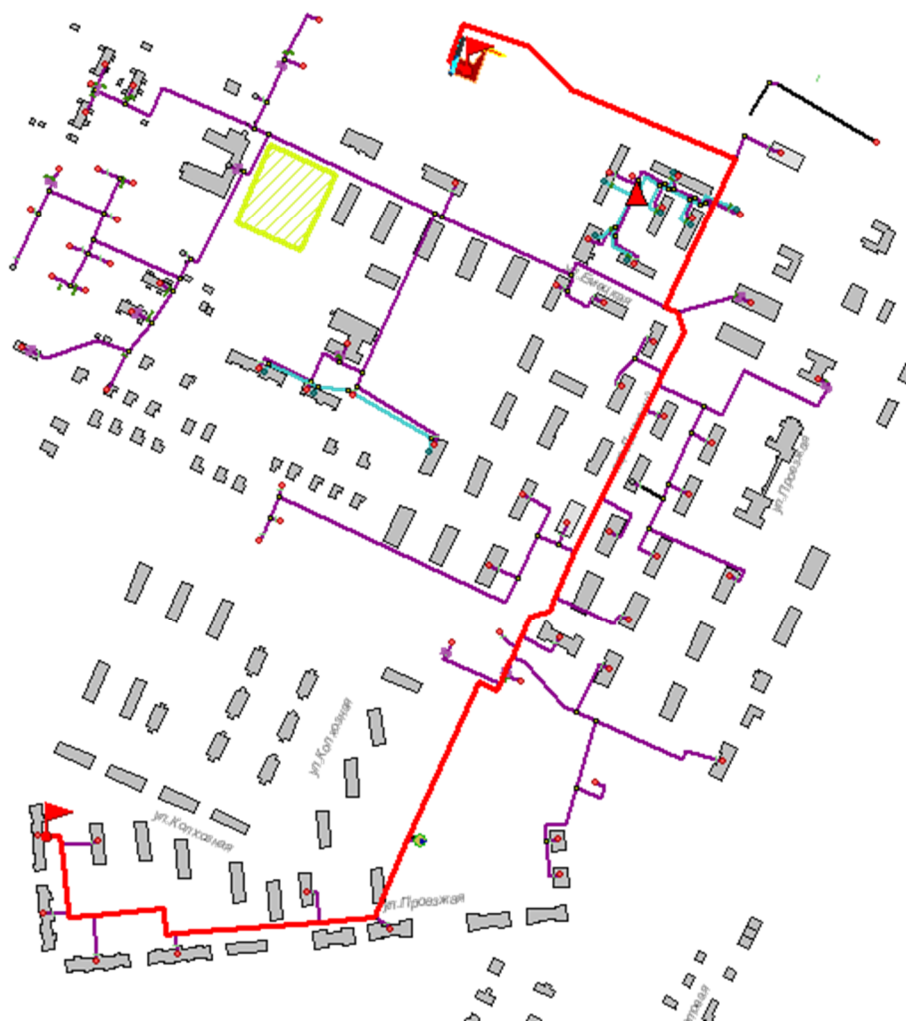
Рисунок 1.65 -Расчетный путь теплоносителя котельной до Колхозная,35
