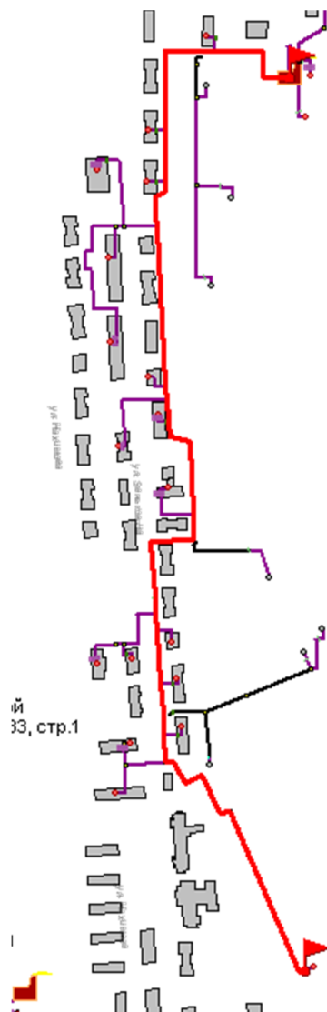
Рисунок 1.25 -Расчетный путь теплоносителя котельной до Пластмассового завода
