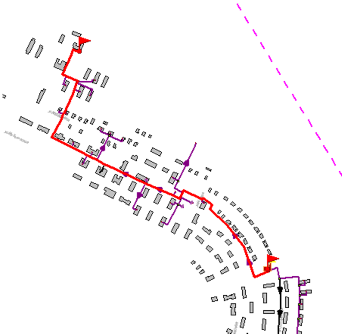
Рисунок 1.91 -Расчетный путь теплоносителя котельной до Карская,15,амбулатория 29л/з
