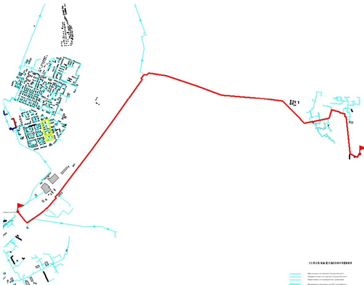
Рисунок 3.7 -Расчетный путь теплоносителя №4 от Архангельской ТЭЦ.
