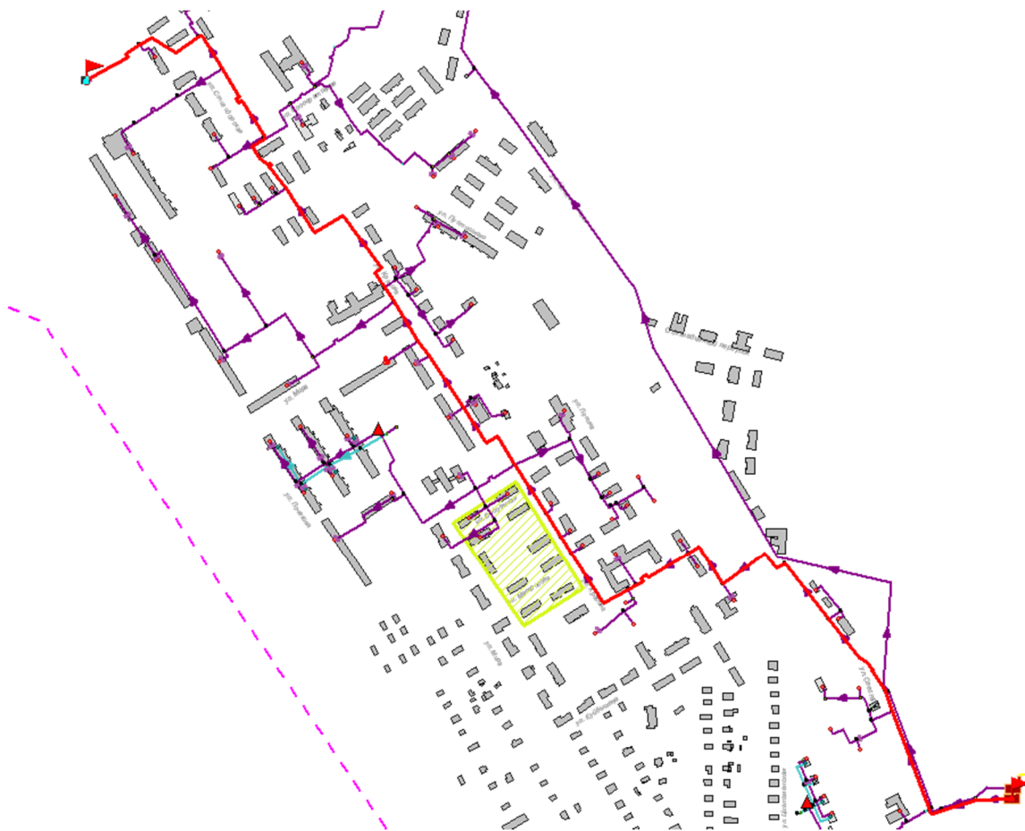
Рисунок 3.11 -Расчетный путь теплоносителя от Цигломенской ТЭС до Лочехина, д.13
