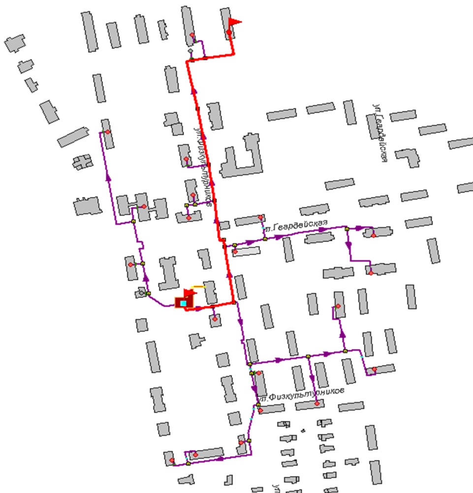
Рисунок 2.67 -Расчетный путь теплоносителя от котельной до Петрова,9
