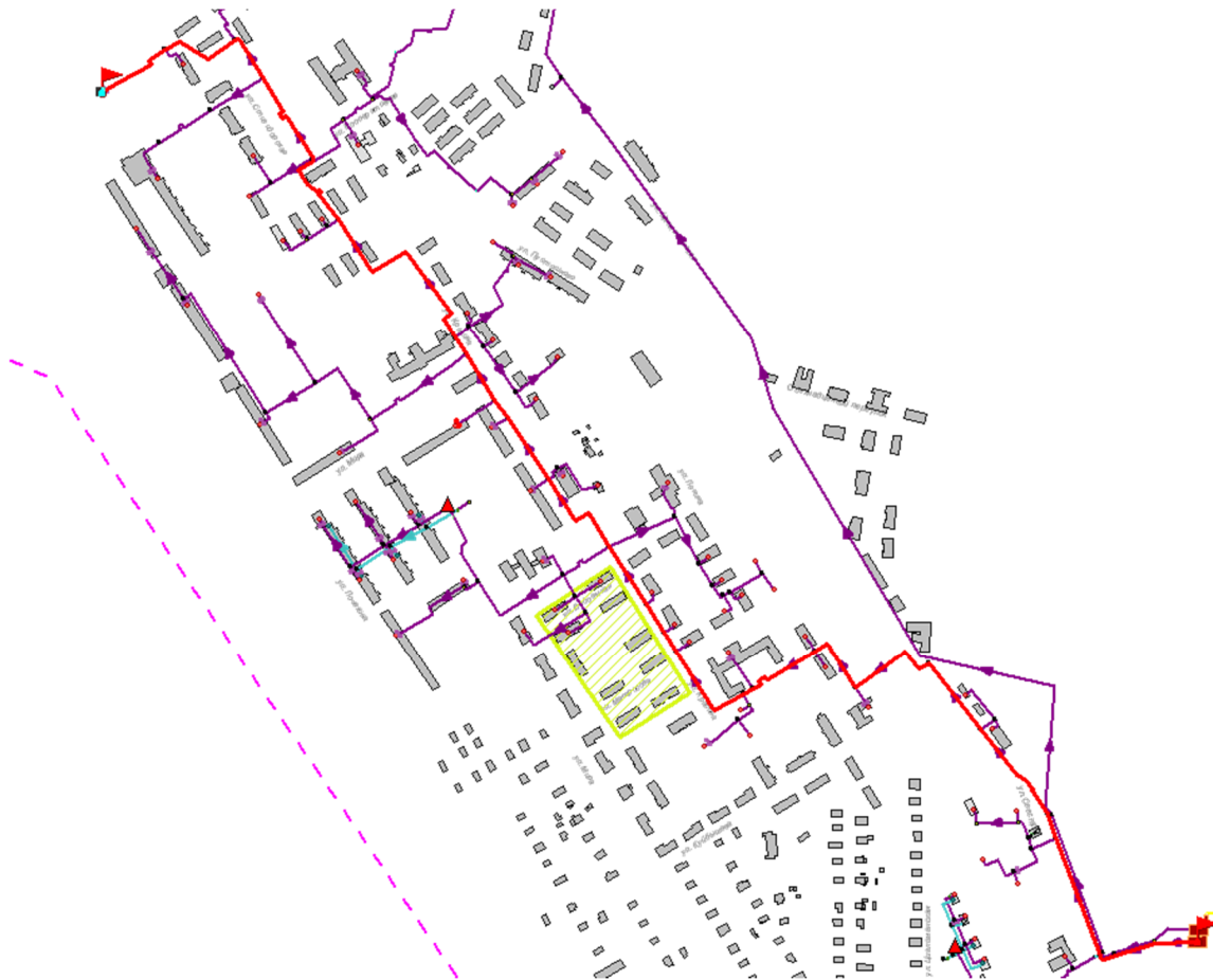
Рисунок 2.11 -Расчетный путь теплоносителя от Цигломенской ТЭС до Лочехина, д.13
