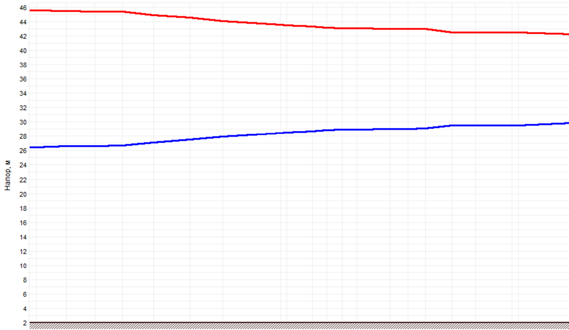
Рисунок 1.16 –График гидравлических режимов рассматриваемого теплопровода
